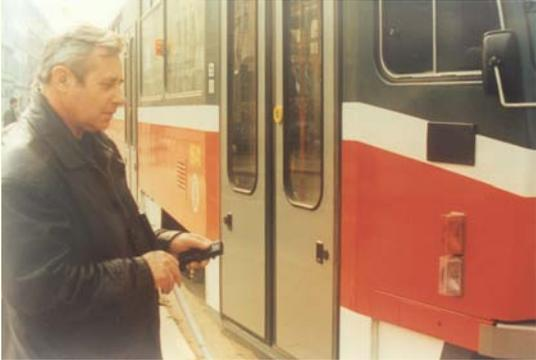
**Informationssystem für Haltestellen: Die aktuelle Situation der Haltestelle (Eisenbahn, Bus, Straßenbahn) wird an einer Anzeige dargestellt. Die blinde Person kann die akustische Form solcher Information aktivieren.**
